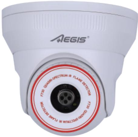
F730 四波段点型红外火焰探测器是一款具备先进设计理念和成熟技术的火焰探测器。该款探测器采用了一个新型四波段红外热释电传感器，通过优秀的电路设计工艺及先进的信号处理算法，大幅提升了探测覆盖范围和抗误报能力。探测器使用了特种工程塑料壳体，大幅减轻了探测器整体重量，更适合对重量有要求的探测场所使用。
